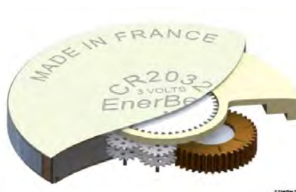
Le microgénérateur inertiel développé par EnerBee.
